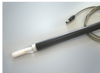
Tensiometer zur Messung der Bodenwasserspannung
