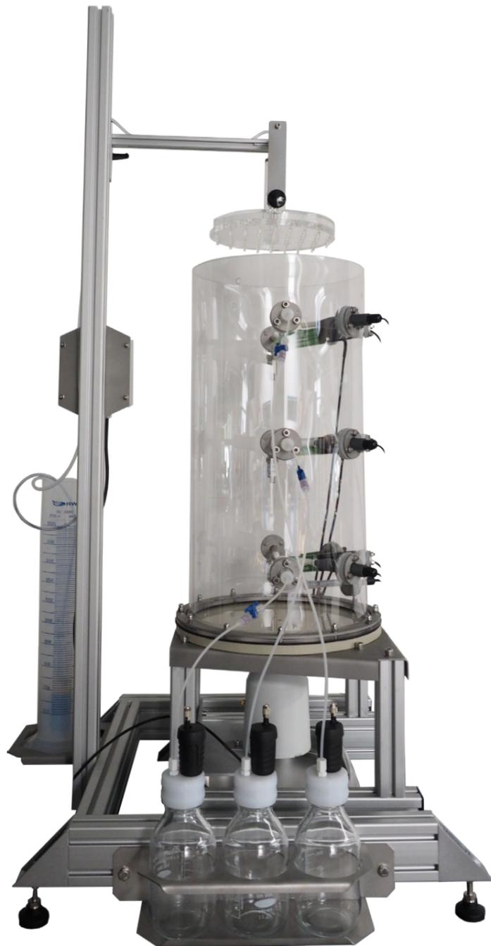
Laborlysimeter mit PET-Lysimetergefäß
